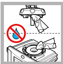
18. Kontrollera att det inte finns vatten på processhuvudet (eller på den automatiska rengöringsenheten). Torka upp allt eventuellt spill för att förhindra att vatten tränger in i kyvettfacket.
