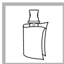
6. Nettoyez et séchez le flacon d'étalon de vérification avec un chiffon non pelucheux. Reportez-vous à la section [Prévention de la contamination des tubes](#) à la page 86.
