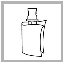
2. Vyčistite a vysušte vialku pomocou utierky, ktorá nezanecháva vlákna. Pozrite [Zabránenie znečisteniu vialky](#) na strane 427.
