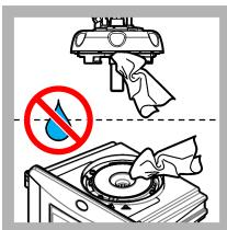
18. Asegúrese de que no haya agua en el cabezal (o en el módulo de limpieza automática). Seque todos los posibles derrames para evitar la entrada de agua en el compartimiento para cubetas.
