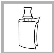
2. Reinigen und trocknen Sie die Küvette mit einem fusselfreien Tuch. Siehe [Verschmutzung der Probenküvette verhindern](#) auf Seite 39.
