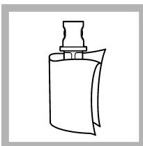
6. Rengör och torka verifieringsstandarden med en ludfri trasa. Se [Förhindra kontaminering i kyvetten](#) på sidan 246.
