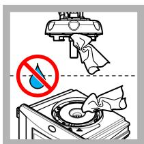
12. Sørg for, at der ikke er vand på proceshovedet (eller det automatiske rengøringsmodul). Tør eventuelle spild op for at undgå vandindtrængen i målekammeret.
