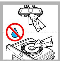
18. Zkontrolujte, že na procesní hlavě (nebo modulu automatického čištění) není voda. Jakoukoliv rozlitou tekutinu osušte, abyste zabránili vniknutí vody do prostoru na kyvety.
