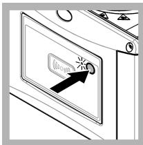
27. Pritisnite gumb na prednjoj strani instrumenta da biste spremili vrijednost kalibracije. Svjetlo indikatora statusa svijetli zeleno.
