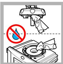
18. Uverite se nema vode na glavi materijala za obradu (ili modulu automatskog čišćenja). Osušite sve delove sa prosutim tečnostima kako biste sprečili da voda prodre u odeljak za boćicu.
