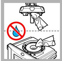
18. Asigurați-vă că nu există apă pe capul de proces (sau pe modulul de curățare automată). Uscați toate scurgerile posibile pentru a preveni infiltrarea apei în compartimentul cuvelor.
