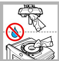
25. Uverite se nema vode na glavi materijala za obradu (ili modulu automatskog čišćenja). Osušite sve delove sa prosutim tečnostima kako biste sprečili da voda prodre u odeljak za boćicu.
