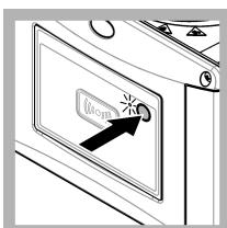
27. A kalibrációs érték mentéséhez nyomja meg a műszer elülső oldalán lévő gombot. Az állapotjelző lámpa zöld marad.
