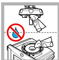
25. Zkontrolujte, že na procesní hlavě (nebo modulu automatického čištění) není voda. Jakoukoliv rozlitou tekutinu osušte, abyste zabránili vniknutí vody do prostoru na kyvety.
