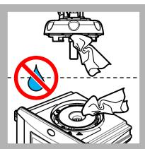
**18.** Sørg for, at der ikke er vand på proceshovedet (eller det automatiske rengøringsmodul). Tør eventuelle spild op for at undgå vandindtrængen i målekammeret.
