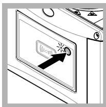
13. Tryk på knappen på instrumentets forside for at gemme kalibreringsværdien. Statusindikatoren lyser grønt.
