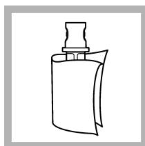
7. Vyčistite a vysušte vialku pomocou utierky, ktorá nezanecháva vĺakna. Pozrite [Zabránenie znečisteniu vialky](#) na strane 427.
