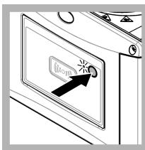
27. Tryck på knappen på framsidan av instrumentet för att spara kalibreringsvärdet. Kontrolllampan för status lyser grönt.
