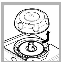
10. Kada svjetlo indikatora statusa počne treperiti zeleno, uklonite poklopac kalibracije.
