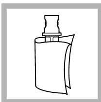
**2.** Tisztítja meg és törölje szárazra a cellát szűkszerűszerrel. Lásd: [A cella szennyeződésének megelőzése](#) oldalon 313.
