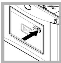
**13.** A kalibrációs érték mentéséhez nyomja meg a műszer előlisi oldalán lévő gombot. Az állapotjelző lámpa zöld marad.
