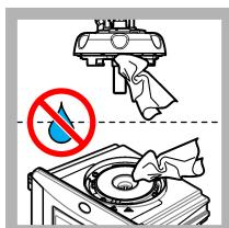
**12.** Asegúrese de que no haya agua en el cabezal (o en el módulo de limpieza automática). Seque todos los posibles derrames para evitar la entrada de agua en el compartimiento para cubetas.
