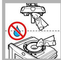
**12.** Uistite sa, že sa v procesnej hlave (ani v automatickom čistiacom module) nenachádza žiadna voda. Akékolvek možné rozliatie treba utriť, aby sa zabránilo vniknutiu vody do priestoru vialky.
