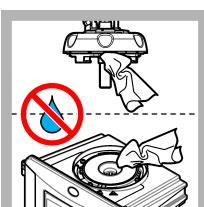
**18.** Provjerite ima li vode na procesnoj glavi (ili modulu za automatsko čišćenje). Obrišite svu tekućinu kako biste sprječili prodiranje vode u odjeljak za bočice.
