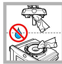
16. Убедитесь, что на измерительном модуле (или модуле автоматической очистки) нет воды. Устранит все разливы, чтобы предотвратить попадание воды в кюветное отделение.
