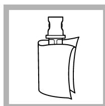
6. Limpe e seque o frasco do padrão de verificação com um pano sem pelos. Consulte a secção [Evitar a contaminação do frasco](#) na página 134.
