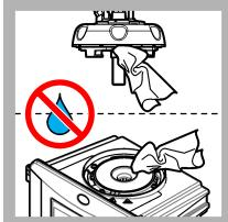
18. Βεβαιωθείτε ότι δεν υπάρχει νερό στην κεφαλή συνεχούς μέτρησης (ή τη μονάδα αυτόματου καθαρισμού). Στεγνώστε όλες τις πιθανές διαρροές για να αποτρέψετε την εισροή νερού στο διαμέρισμα φιαλίδιων.
