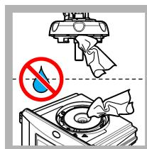
**12.** Assurez-vous qu'il n'y a pas d'eau sur la tête de contrôle (ou sur l'unité de nettoyage automatique). Séchez tous les fluides déversés possibles afin d'éviter toute entrée d'eau dans le puits de mesure.
