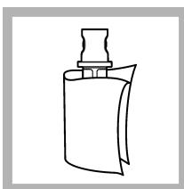
6. Vyčistite a vysušte vialku s overovacím štandardom pomocou utierky, ktorá nezanecháva vlákna. Pozrite [Zabránenie znečisteniu vialky](#) na strane 427.
