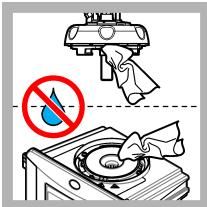
18. Stellen Sie sicher, dass sich kein Wasser auf dem Prozesskopf (oder dem automatischen Reinigungsmodul) befindet. Trocknen Sie alle möglichen verschütteten Flüssigkeiten, um das Eindringen von Wasser in den Küvettenschacht zu verhindern.
