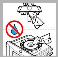
25. Assicurarsi che non vi sia acqua sul regolatore di processo (o sul modulo di pulizia automatica). Asciugare tutte le eventuali fuoriuscite per evitare l'ingresso di acqua nel vano fiale.
