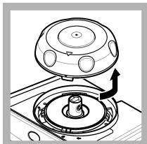
10. Quando la luce della spia di stato lampeggia di colore verde, rimuovere il coperchio di calibrazione.
