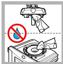
**12.** Stellen Sie sicher, dass sich kein Wasser auf dem Prozesskopf (oder dem automatischen Reinigungsmodul) befindet. Trocknen Sie alle möglichen verschütteten Flüssigkeiten, um das Eindringen von Wasser in den Küvettenschacht zu verhindern.
