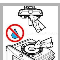
**18.** Uistite sa, že sa v procesnej hlave (ani v automatickom čistiaciom module) nenachádza žiadna voda. Akékoľvek možné rozliatie treba utrieť, aby sa zabránilo vniknutiu vody do priestoru vialky.
