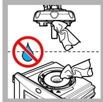
16. Asegúrese de que no haya agua en el cabezal (o en el módulo de limpieza automática). Seque todos los posibles derrames para evitar la entrada de agua en el compartimiento para cubetas.
