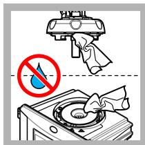
18. Убедитесь, что на измерительном модуле (или модуле автоматической очистки) нет воды. Устранимте все разливы, чтобы предотвратить попадание воды в кюветное отделение.
