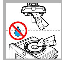
16. Sørg for, at der ikke er vand på proceshovedet (eller det automatiske rengøringsmodul). Tør eventuelle spild op for at undgå vandindtrængen i målekammeret.
