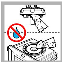
25. Убедитесь, что на измерительном модуле (или модуле автоматической очистки) нет воды. Устригите все разливы, чтобы предотвратить попадание воды в зону измерения.
