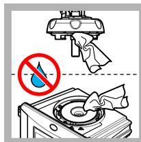
**16.** Uverite se nema vode na glavi materijala za obradu (ili modulu automatskog čišćenja). Osušite sve delove sa prosutim tečnostima kako biste sprečili da voda prodre u odeljak za bočicu.
