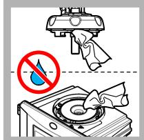
**12.** Zkontrolujte, že na procesní hlavě (nebo modulu automatického čištění) není voda. Jakoukoliv rozlitou tekutinu osušte, abyste zabránili vniknutí vody do prostoru na kyvety.
