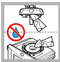
12. Asigurați-vă că nu există apă pe capul de proces (sau pe modulul de curățare automată). Uscați toate surgerile posibile pentru a preveni infiltrarea apei în compartimentul cuvelor.
