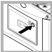
27. Pulse el botón de la parte frontal del instrumento para guardar el valor de la calibración. La luz indicadora de estado permanece en verde.
