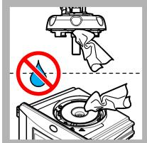
11. Asigurați-vă că nu există apă pe capul de proces (sau pe modulul de curățare automată). Uscați toate surgerile posibile pentru a preveni infiltrarea apei în compartimentul cuvelor.
