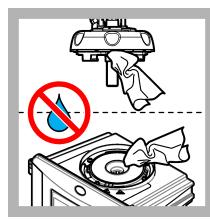
**16.** Provjerite ima li vode na procesnoj glavi (ili modulu za automatsko čišćenje). Obrišite svu tekućinu kako biste spriječili prodiranje vode u odjeljak za boćice.
