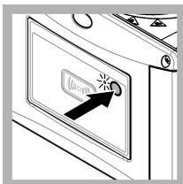
27. Prima o botão na parte dianteira do equipamento para guardar o valor de calibração. A luz indicadora de estado permanece verde.
