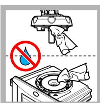
**18.** Provjerite ima li vode na procesnoj glavi (ili modulu za automatsko čišćenje). Obrišite svu tekućinu kako biste sprječili prodiranje vode u odjeljak za boćice.
