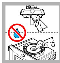
16. Uistite sa, že sa v procesnej hlave (ani v automatickom čistiacom module) nenachádza žiadna voda. Akékolvek možné rozliatie treba utrieť, aby sa zabránilo vniknutiu vody do priestoru vialky.
