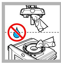
16. Zorg ervoor dat er geen water op de proceskop (of de automatische reinigingsmodule) aanwezig is. Droog alle gemorste vloeistof om te voorkomen dat water de meetkanaal binnendringt.
