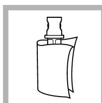
6. Reinigen und trocknen Sie die Verifizierungsstandardküvette mit einem fusselfreien Tuch. Siehe [Verschmutzung der Probenküvette verhindern](#) auf Seite 39.
