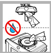
25. Asegúrese de que no haya agua en el cabezal (o en el módulo de limpieza automática). Seque todos los posibles derrames para evitar la entrada de agua en el compartimiento para cubetas.
