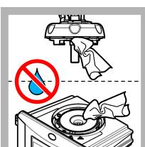
18. Uverite se nema vode na glavi materijala za obradu (ili modulu automatskog čišćenja). Osušite sve delove sa prosutim tečnostima kako biste sprečili da voda prodre u odeljak za bočicu.
