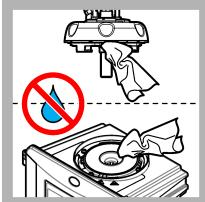
18. Certifique-se de que não existe água na cabeça de processo (ou no módulo de limpeza automática). Seque todos os possíveis derrames para evitar a entrada de água no compartimento do frasco.
