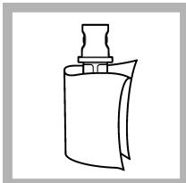
2. Reinigen und trocknen Sie die Küvette mit einem fettfreien Tuch. Siehe [Verschmutzung der Probenküvette verhindern](#) auf Seite 39.
