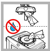
12. Убедитесь, что на измерительном модуле (или модуле автоматической очистки) нет воды. Устранимте все разливы, чтобы предотвратить попадание воды в кюветное отделение.
