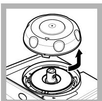
**10.** Cuando la luz indicadora de estado parpadee en verde, retire la tapa de calibración.
