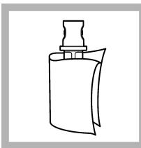
**2.** Vialo očistite in posušite s kropo, ki ne pušča vlaken. Glejte [Preprečevanje kontaminacije viale](#) na strani 448.
