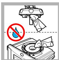
25. Uistite sa, že sa v procesnej hlave (ani v automatickom čistiaci module) nenachádza žiadna voda. Akékolvek možné rozliatie treba utrieť, aby sa zabránilo vniknutiu vody do priestoru vialky.
