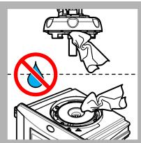
25. Βεβαιωθείτε ότι δεν υπάρχει νερό στην κεφαλή συνεχούς μέτρησης (ή τη μονάδα αυτόματου καθαρισμού). Στεγνώστε όλες τις πιθανές διαρροές για να αποτρέψετε την εισροή νερού στο διαμέρισμα φιαλιδίων.
