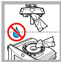
25. Provjerite ima li vode na procesnoj glavi (ili modulu za automatsko čišćenje). Obrisite svu tekućinu kako biste spriječili prodiranje vode u odjeljak za bočice.
