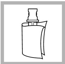
2. Vialo očistite in posušite s kropo, ki ne pušča vlaken. Glejte [Preprečevanje kontaminacije viale](#) na strani 448.
