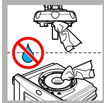
**11.** Βεβαιωθείτε ότι δεν υπάρχει νερό στην κεφαλή συνεχούς μέτρησης (ή τη μονάδα αυτόματου καθαρισμού). Στεγνώστε όλες τις πιθανές διαρροές για να αποτρέψετε την εισροή νερού στο διαμέρισμα φιαλίδιων.
