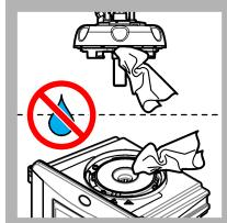
25. Sørg for, at der ikke er vand på proceshovedet (eller det automatiske rengøringsmodul). Tør eventuelle spild op for at undgå vandindtrængen i målekanneret.
