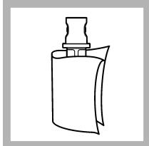
6. Pulire e asciugare la fiala dello standard di verifica con un panno che non rilascia pelucchi. Fare riferimento a [Prevenzione contro la contaminazione delle fiale](#) a pagina 63.
