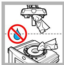
**12.** Βεβαιωθείτε ότι δεν υπάρχει νερό στην κεφαλή συνεχούς μέτρησης (ή τη μονάδα αυτόματου καθαρισμού). Στεγνώστε όλες τις πιθανές διαρροές για να αποτρέψετε την εισροή νερού στο διαμέρισμα φιαλιδίων.
