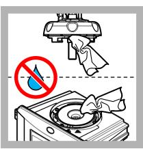
11. Zkontrolujte, že na procesní hlavě (nebo modulu automatického čištění) není voda. Jakoukoliv rozlitou tekutinu osušte, abyste zabránili vniknutí vody do prostoru na kyvety.
