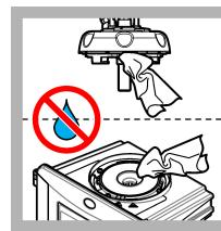
16. Kontrollera att det inte finns vatten på processhuvudet (eller på den automatiska rengöringsenheten). Torka upp allt eventuellt spill för att förhindra att vatten tränger in i kyvettfacket.
