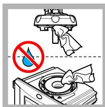
**12.** Kontrollera att det inte finns vatten på processhuvudet (eller på den automatiska rengöringsenheten). Torka upp allt eventuellt spill för att förhindra att vatten tränger in i kyvettfacket.
