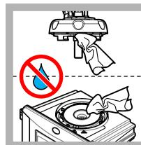
**16.** Stellen Sie sicher, dass sich kein Wasser auf dem Prozesskopf (oder dem automatischen Reinigungsmo- du) befindet. Trocknen Sie alle möglichen verschütteten Flüssigkeiten, um das Eindringen von Wasser in den Küvettenschacht zu verhindern.
