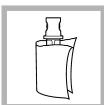
6. Hadříkem nepouštějícím vlákna očistěte a vysušte kyvetu na ověřovací standard. Viz [Prevence kontaminace kyvety](#) na straně 155.
