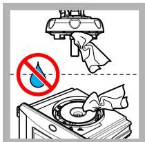
12. Assicurarsi che non vi sia acqua sul regolatore di processo (o sul modulo di pulizia automatica). Asciugare tutte le eventuali fuoriuscite per evitare l'ingresso di acqua nel vano fiale.
