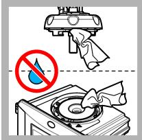
18. Assurez-vous qu'il n'y a pas d'eau sur la tête de contrôle (ou sur l'unité de nettoyage automatique). Séchez tous les fluides déversés possibles afin d'éviter toute entrée d'eau dans le puits de mesure.
