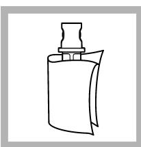
2. Očistěte a vysušte kyvetu pomocí hadříku nepouštějícího vlákna. Viz [Prevence kontaminace kyvety](#) na straně 155.
