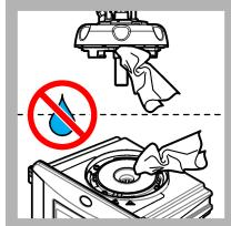
16. Certifique-se de que não existe água na cabeça de processo (ou no módulo de limpeza automática). Seque todos os possíveis derrames para evitar a entrada de água no compartimento do frasco.
