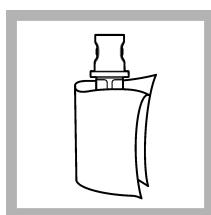
6. Očistite i obrišite bočicu standarda za verifikaciju tkatinom koja ne ostavlja vlakna. Pogledajte [Sprečavanje prljavišta boćice](#) na stranici 535.
