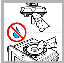
11. Certifique-se de que não existe água na cabeça de processo (ou no módulo de limpeza automática). Seque todos os possíveis derrames para evitar a entrada de água no compartimento do frasco.
