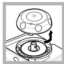
10. Когда световой индикатор состояния начнет мигать зеленым цветом, снимите крышку для калибровки.
