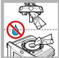
18. Assicurarsi che non vi sia acqua sul regolatore di processo (o sul modulo di pulizia automatica). Asciugare tutte le eventuali fuoriuscite per evitare l'ingresso di acqua nel vano fiale.
