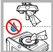
18. Zorg ervoor dat er geen water op de proceskop (of de automatische reinigingsmodule) aanwezig is. Droog alle gemorste vloeistof om te voorkomen dat water de meetschacht binnendringt.
