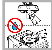
16. Assicurarsi che non vi sia acqua sul regolatore di processo (o sul modulo di pulizia automatica). Asciugare tutte le eventuali fuoriuscite per evitare l'ingresso di acqua nel vano fiale.
