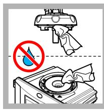
16. Zkontrolujte, že na procesní hlavě (nebo modulu automatického čištění) není voda. Jakoukoliv rozlitou tekutinu osušte, abyste zabránili vniknutí vody do prostoru na kyvety.
