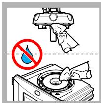
25. Certifique-se de que não existe água na cabeça de processo (ou no módulo de limpeza automática). Seque todos os possíveis derrames para evitar a entrada de água no compartimento do frasco.
