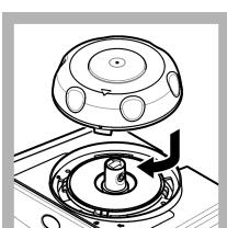
6. Instale a tampa de calibração. Certifique-se de que a tampa de calibração está na posição fechada. Consulte [Instalação](#) na página 119.
