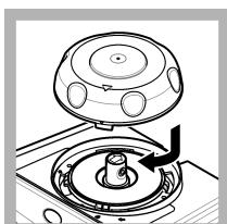
6. Setzen Sie den Kalibrierdeckel wieder auf. Stellen Sie sicher, dass sich der Kalibrierdeckel in geschlossener Position befindet. Siehe [Installation](#) auf Seite 24.
