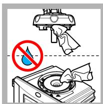
12. Provjerite ima li vode na procesnoj glavi (ili modulu za automatsko čišćenje). Obrišite svu tekućinu kako biste spriječili prodiranje vode u odjeljak za bočice.
