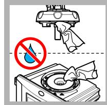
16. Asigurați-vă că nu există apă pe capul de proces (sau pe modulul de curățare automată). Uscați toate scurgerile posibile pentru a preveni infiltrarea apei în compartimentul cuvelor.
