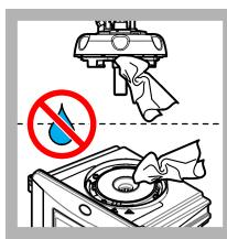
16. Assurez-vous qu'il n'y a pas d'eau sur la tête de contrôle (ou sur l'unité de nettoyage automatique). Séchez tous les fluides déversés possibles afin d'éviter toute entrée d'eau dans le puits de mesure.
